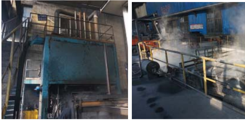
图 13-5 传统振动成型工段和炭块冷却工段废气收集方式
