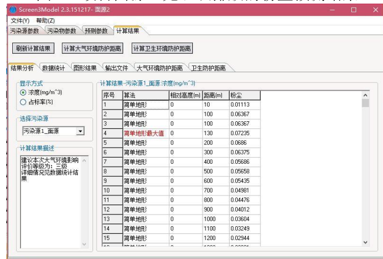
图 5 项目面源 2 无组织排放的粉尘预测结果
